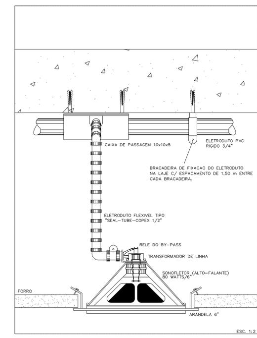
DETALHE GERAL INSTALAÇÃO DOS SONOFLETORES S/ ESCALA
