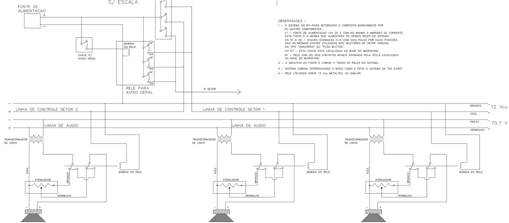
DETALHE GERAL DE LIGAÇÃO SISTEMA DE ÁUDIO COM BY-PASS SEM ESCALA
